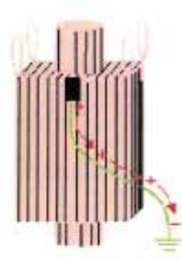
Figura 2: Contenedor flexible Tipo C, conectado a tierra.
